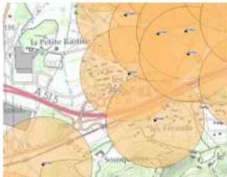
Figure 1: Etape 1 - Définition des zones tampon de 300 m autour des bornes d'irrigation
